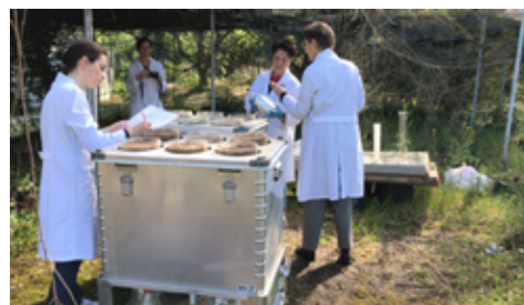
Campionamento di suolo contaminato e allestimento di microcosmi terrestri, secondo la guida standard ASTM E1197-872004
