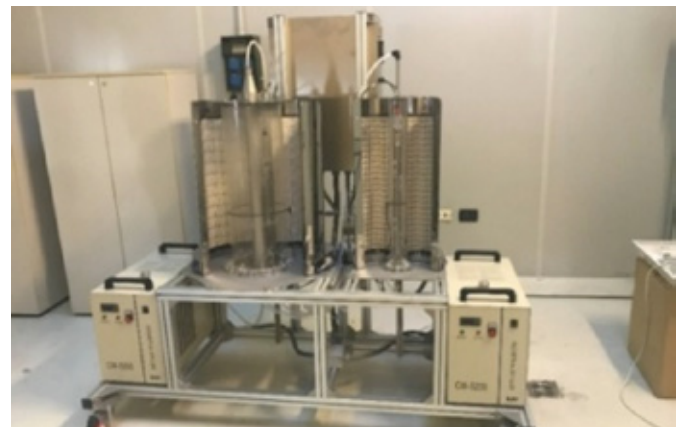
Sistema di fotobioreattori "bubble column" per la coltivazione di microalghe
