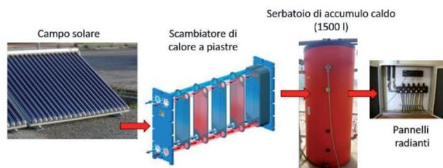
Funzionamento in Solar Heating
