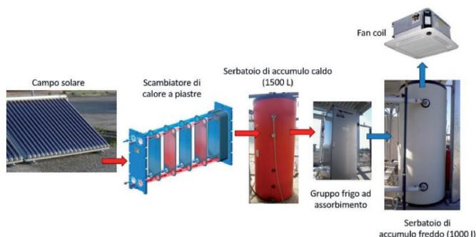
Funzionamento in Solar Cooling
