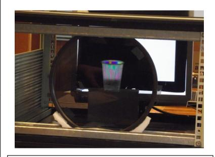
Un dispositivo realizzato da studenti in alternanza scuola-lavoro, in cui un bicchiere di plastica, investito da luce polarizzata si vede colorato se osservato dietro un secondo polarizzatore.
