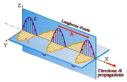
In una singola onda elettromagnetica che si propaga nel vuoto, i campi vettoriali elettrico e magnetico oscillano lungo il piano ortogonale alla direzione di propagazione e sono anche ortogonali tra di loro.
