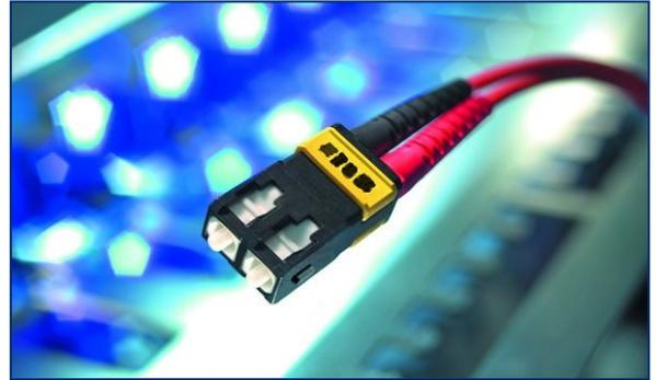
nelle fibre stesse; la bassa attenuazione del segnale, grazie alle proprietà di confinamento e di trasparenza dei vetri usati; l'immunità da interferenze elettromagnetiche, propria dei materiali dielettrici; la sicurezza da intercettazioni, difficili da effettuare e facili da rilevare; infine il peso, le dimensioni ridotte e le notevoli proprietà meccaniche (resistenza a trazione simile a quella dell'acciaio, flessibilità, ecc.).
