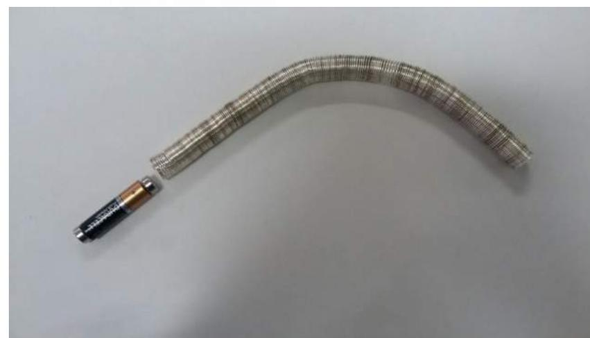
I morsetti della batteria sono in contatto elettrico con i magneti; in tal modo quando i magneti con la pila vengono inseriti nel solenoide, si forma un circuito chiuso in cui scorre corrente. La corrente, a sua volta, genera un campo magnetico che attrae (o respinge) i magneti provocandone lo spostamento all'interno del solenoide (vedi figura).
