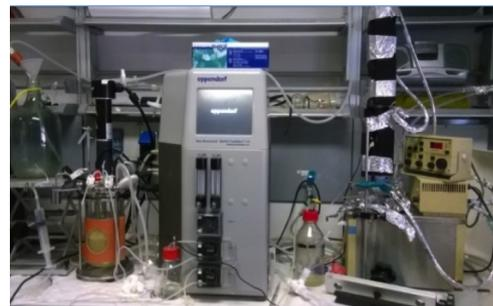
Fermentatore automatizzato (3L) per la produzione di idrogeno ed etanolo da glicerolo grezzo
